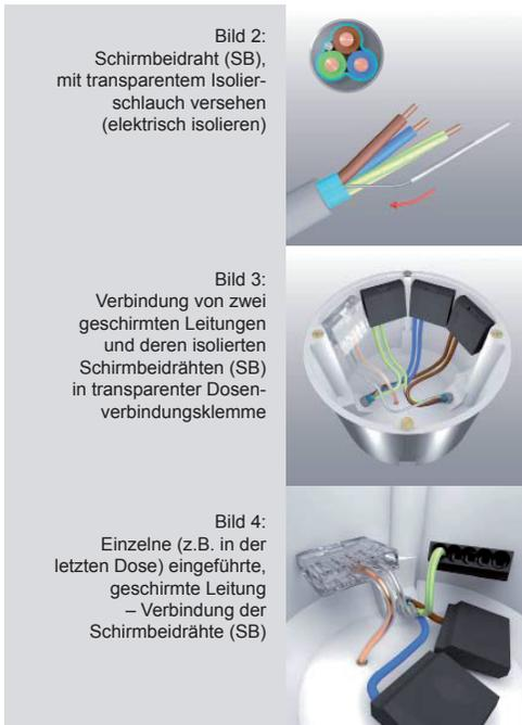
Bild 2: Schirmbeidraht (SB), mit transparentem Isolierschlauch versehen (elektrisch isolieren)
